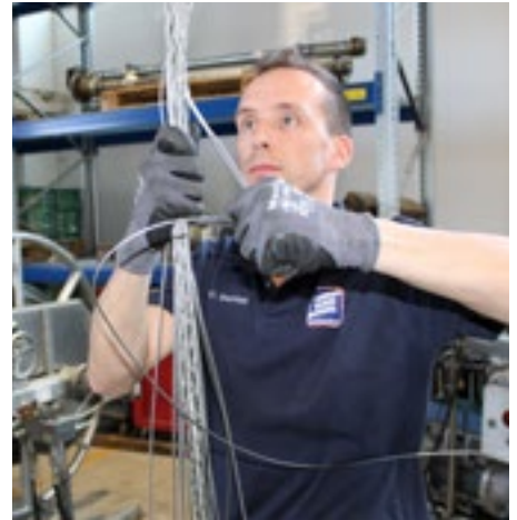
Service – Seilflechter beim Spleiß eines Draht-Vorseils / Service – Seilflechter splices a braided wire pull rope.
