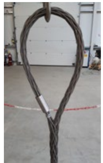
Service – Seilflechter beim Spleiß eines Draht-Vorseils / Service – Seilflechter splices a braided wire pull rope.
