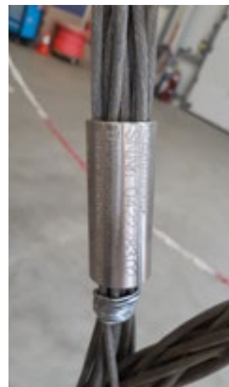
Service – Seilflechter beim Spleiß eines Draht-Vorseils / Service – Seilflechter splices a braided wire pull rope.
